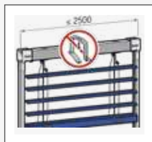
Construction de stores autoporteuse
